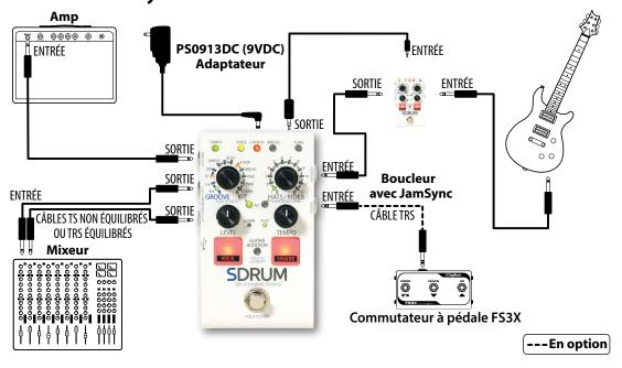
**REMARQUE:** Le looper doit être placé avant la SDRUM dans la plupart des cas, comme lorsque seul le jack AMP OUT est utilisé. En cas d'utilisation des jacks AMP et MIXER OUT, le looper peut aussi être placé entre la SDRUM et l'ampli, si vous le souhaitez. Voir *'Using JamSync' on page 31* pour des informations sur l'utilisation de la SDRUM dans une installation JamSync.
