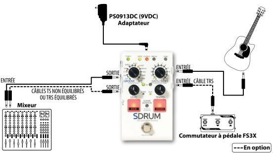
**REMARQUE:** Lorsque seuls les jacks MIXER OUT sont utilisés, le signal guitare mono et le signal batterie stéréo sont alimentés vers les jacks MIXER OUT. Cette installation fonctionne bien pour les applications dans lesquelles une guitare acoustique équipée d'un micro ou une guitare basse sont connectées à un système de sonorisation en direct. Voir *'Output Jack Operation' on page 10* pour de plus amples détails.
