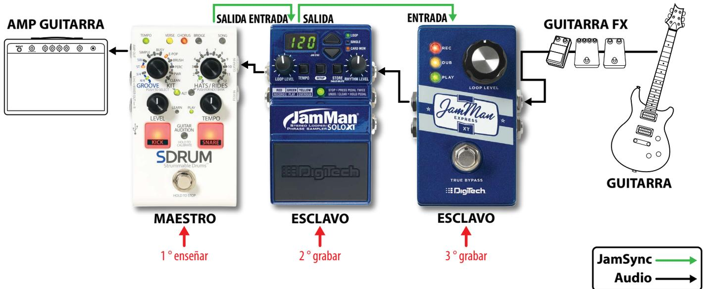
**NOTA:** Cuando el audio se conecta en cascada a través de múltiples loopers JamMan en serie y utilizando JamSync (como se muestra en el diagrama anterior), el SDRUM (el maestro) debería ser el último de la cadena en la mayoría de los casos. Luego necesitará enseñar primero el SDRUM, luego grabar en el penúltimo dispositivo, etc., trabajando hacia atrás a través de la cadena de señal. Al ejecutar esas acciones se asegurará de que graba solo lo que desea durante cada pase.
