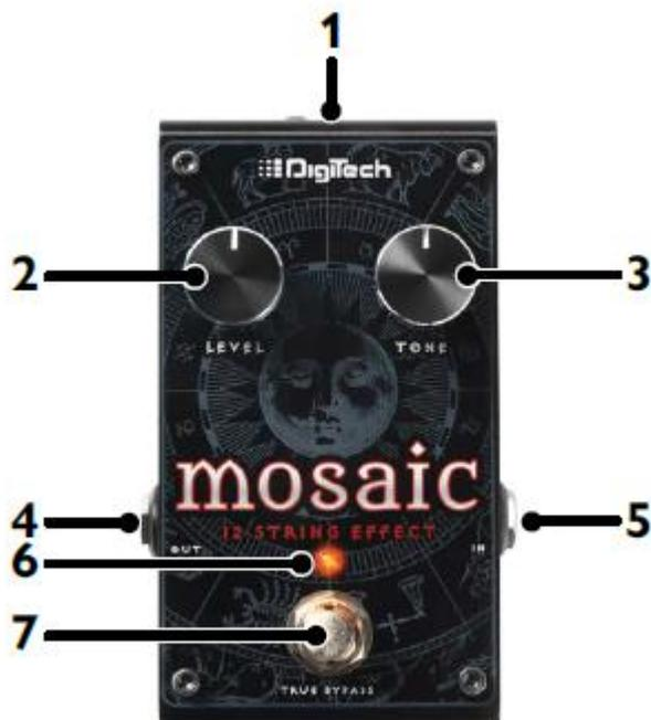
1. Connettore di alimentazione: collegare l'adattatore di alimentazione fornito a questo jack. Non utilizzare alimentatori diversi da quello fornito.
