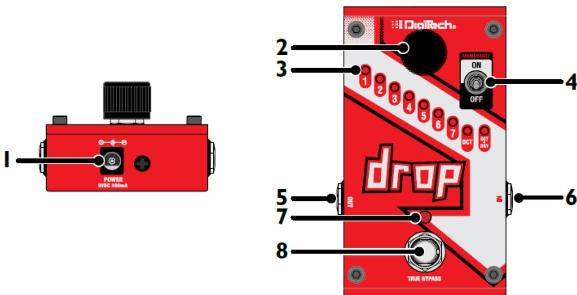
1. Conector de alimentação: Conecte o adaptador de alimentação fornecido a esta tomada. Não use nenhum adaptador de energia diferente do fornecido.
